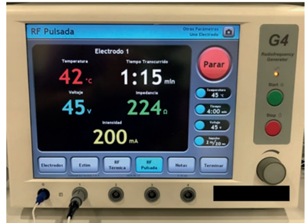
Figura 1. Generador de radiofrecuencia con cuatro canales de tratamiento. Puede observarse el voltaje utilizado, la intensidad de campo, la temperatura alcanzada, la impedancia y el tiempo. Se ha ocultado la casa comercial.
