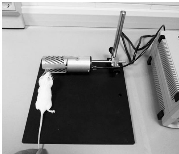
Figura 2. El test de fuerza de agarre, o grip strength test , mide la fuerza requerida para que el ratón o rata se suelte de la rejilla.
